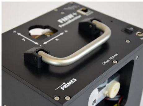
FMW+ は、特殊な測定チップでレーザービームをスキャンする光学機械式スキャンタイプのレーザー計測システムです。測定チップにはレーザービームの一部を通過させる小さな穴（通常直径：約20 $\mu\text{m}$ ）が備わっています。穴を通過したレーザービームの一部は2つの反射ミラーで反射され、使用するレーザーパワーと波長に応じて選択され設定されたディテクタに導かれます。
