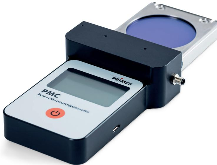
PowerMeasuringCassette パワーメジャリングカセット (PMC) は、固体レーザーのパワー測定を目的としています。保護ガラスカートリッジの代わりに加工ヘッドに設置します。PMCはTrumpf (BEOD70)、Precitec (YW52)、Scansonic (AL03) 加工ヘッドで利用できます。
