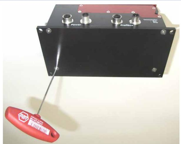
2. Stellen Sie mit den Drehschaltern A und B die gewünschte Busadresse ein. Die Pfeilspitze des Drehschalters muss auf die entsprechende Ziffer zeigen.
