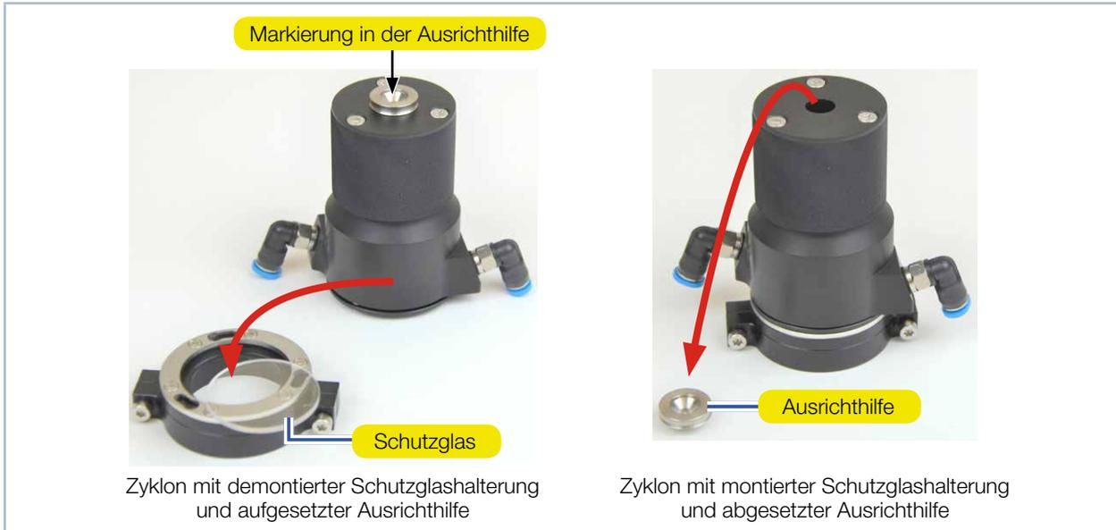
Abb. 8.4: Ausrichthilfe für einen optionalen Zyklon am Beispiel eines Messobjektivs mit 3,3-facher Vergrößerung
