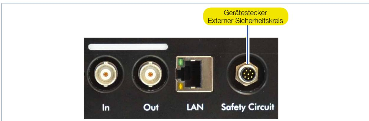
Abb. 10.3: Gerätestecker des externen Sicherheitskreis im Anschlussfeld
