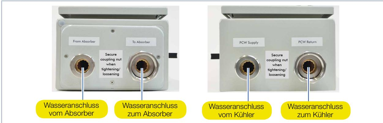
Abb. 7.3: Wasseranschlüsse PLM 40
