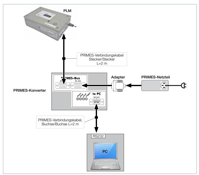
Abb. 8.9: Anschluss an den PC über RS232 und PRIMES-Konverter
