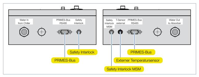
Abb. 8.3: Elektrische Anschlüsse PLM 10 und PLM 20 an der Seite
