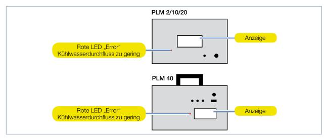
Abb. 4.1: Komponenten des PowerLossMonitor PLM
