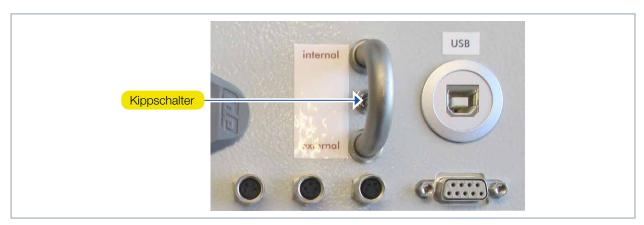
Abb. 8.6: Kippschalter für das Umschalten der Temperaturmessstellen
