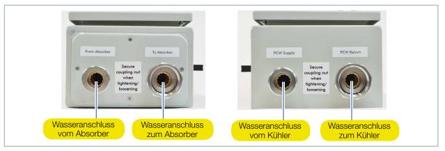
Abb. 7.3: Wasseranschlüsse PLM 40
