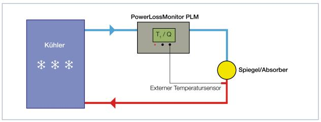
Abb. 4.2: Schematische Darstellung der Messanordnung mit externem Temperatursensor
