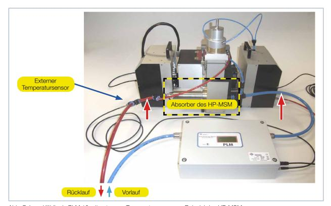
Abb. 7.4: Kühlkreis PLM 10 mit externem Temperatursensor am Beispiel des HP-MSM
