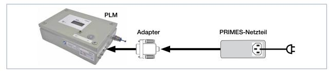
Abb. 8.7: Spannungsversorgung anschließen
