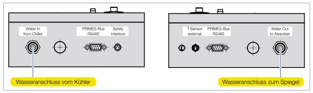
Abb. 7.1: Wasseranschlüsse PLM 2
