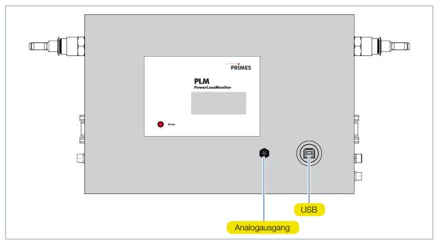
Abb. 8.2: Elektrische Anschlüsse PLM 2 an der Oberseite
