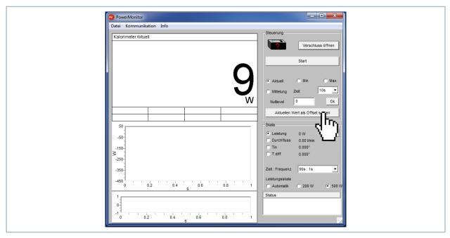
Abb. 10.1: Benutzeroberfläche der PowerMonitorSoftware PMS
