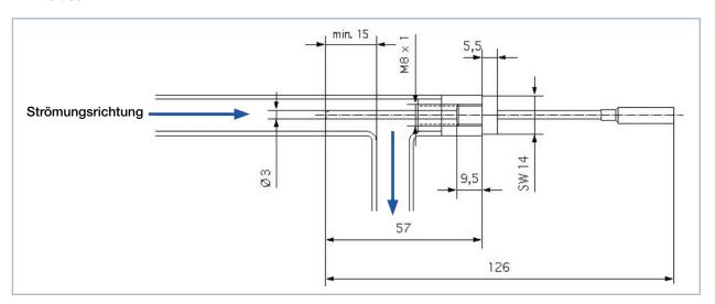
Abb. 9.1: Einbau des externen Temperatursensors
