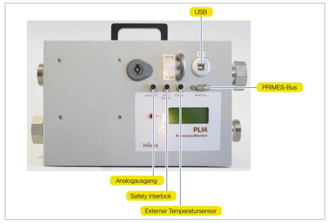
Abb. 8.5: Elektrische Anschlüsse PLM 40
