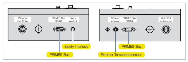
Abb. 8.1: Elektrische Anschlüsse PLM 2 an der Seite
