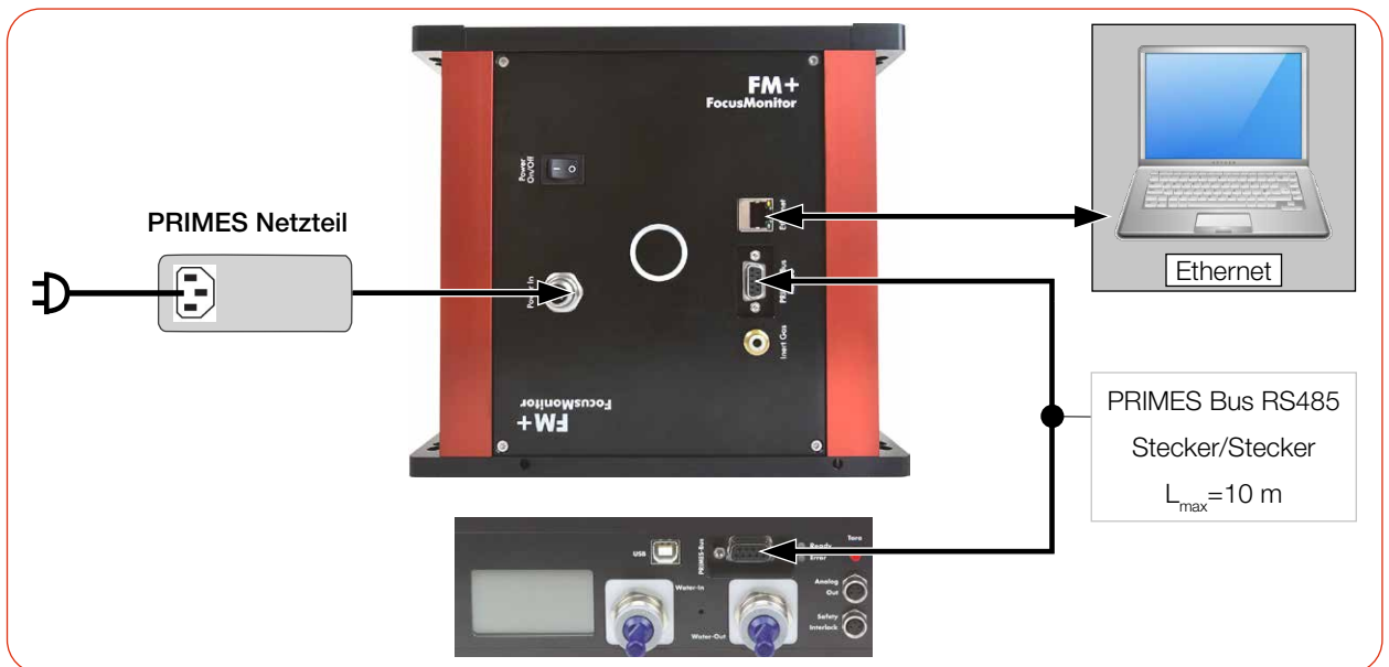
Abb. D.1: Anschluss des FocusMonitor FM+ mit dem CPM (am Beispiel des CPM F-10)
