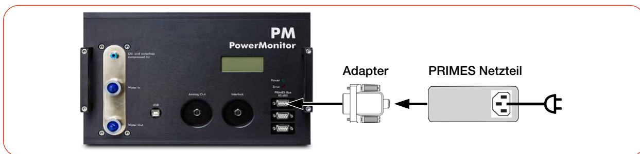
Abb. 8.4: Spannungsversorgung über PRIMES Netzteil, Anzeige der Messwerte am Gerät (am Beispiel des PM 100)
