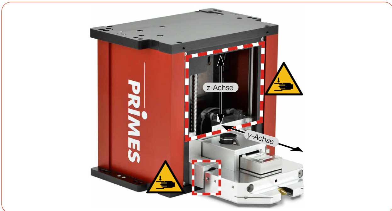
Abb. 4.4: Verletzungsgefahr im Verfahrbereich der Schlitten
