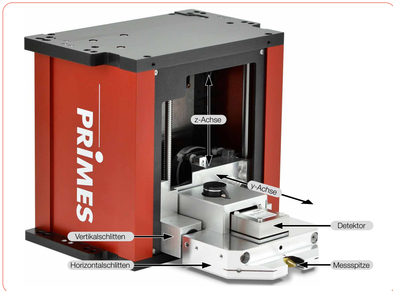
Abb. 4.1: Komponenten des FocusMonitor FM+
