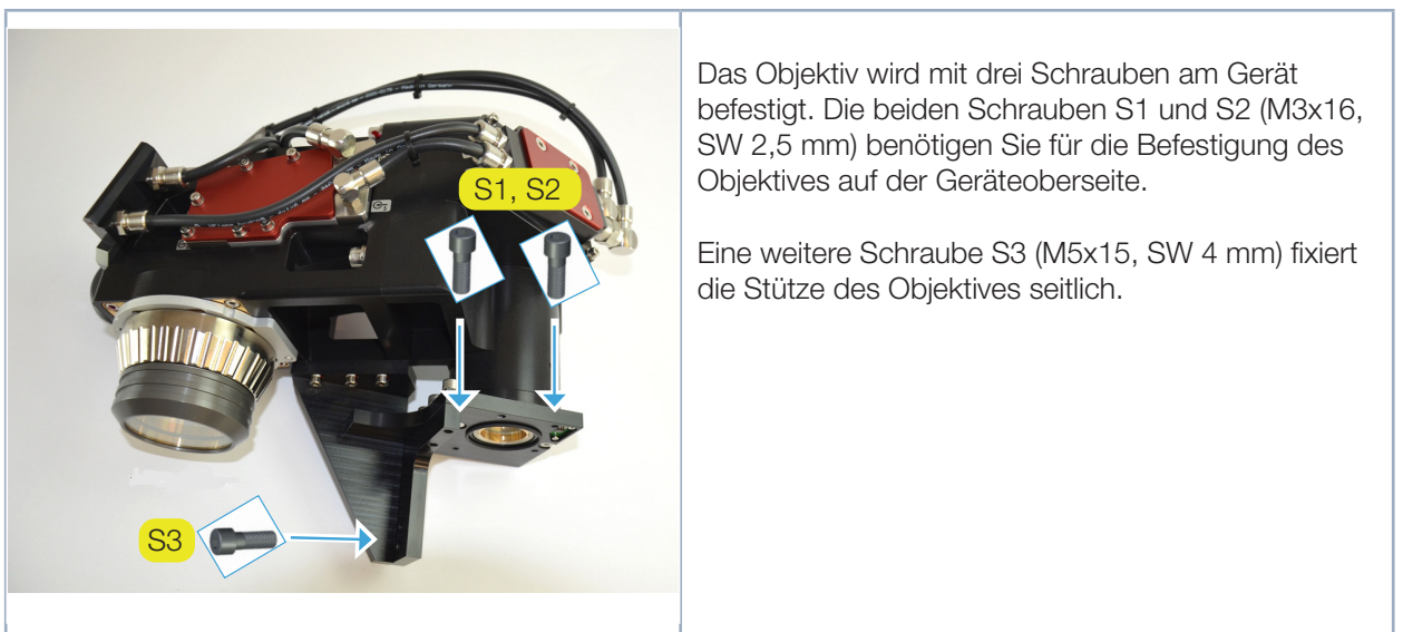
Abb. 11.2: Befestigungsschrauben am Messobjektiv
