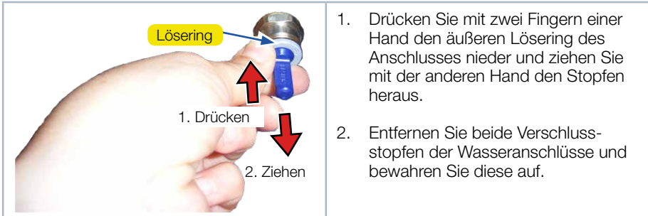
Abb. 6.1: Verschlussstopfen der Wasseranschlüsse entfernen
