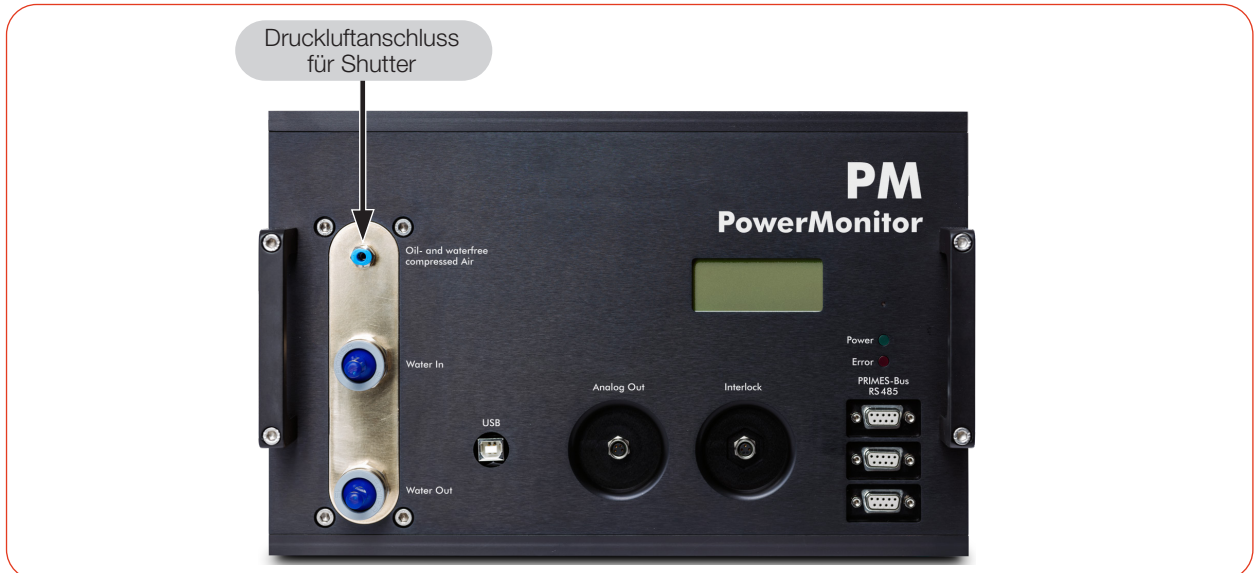
Abb. 7.7: Druckluftanschluss (am Beispiel des PM 100)
