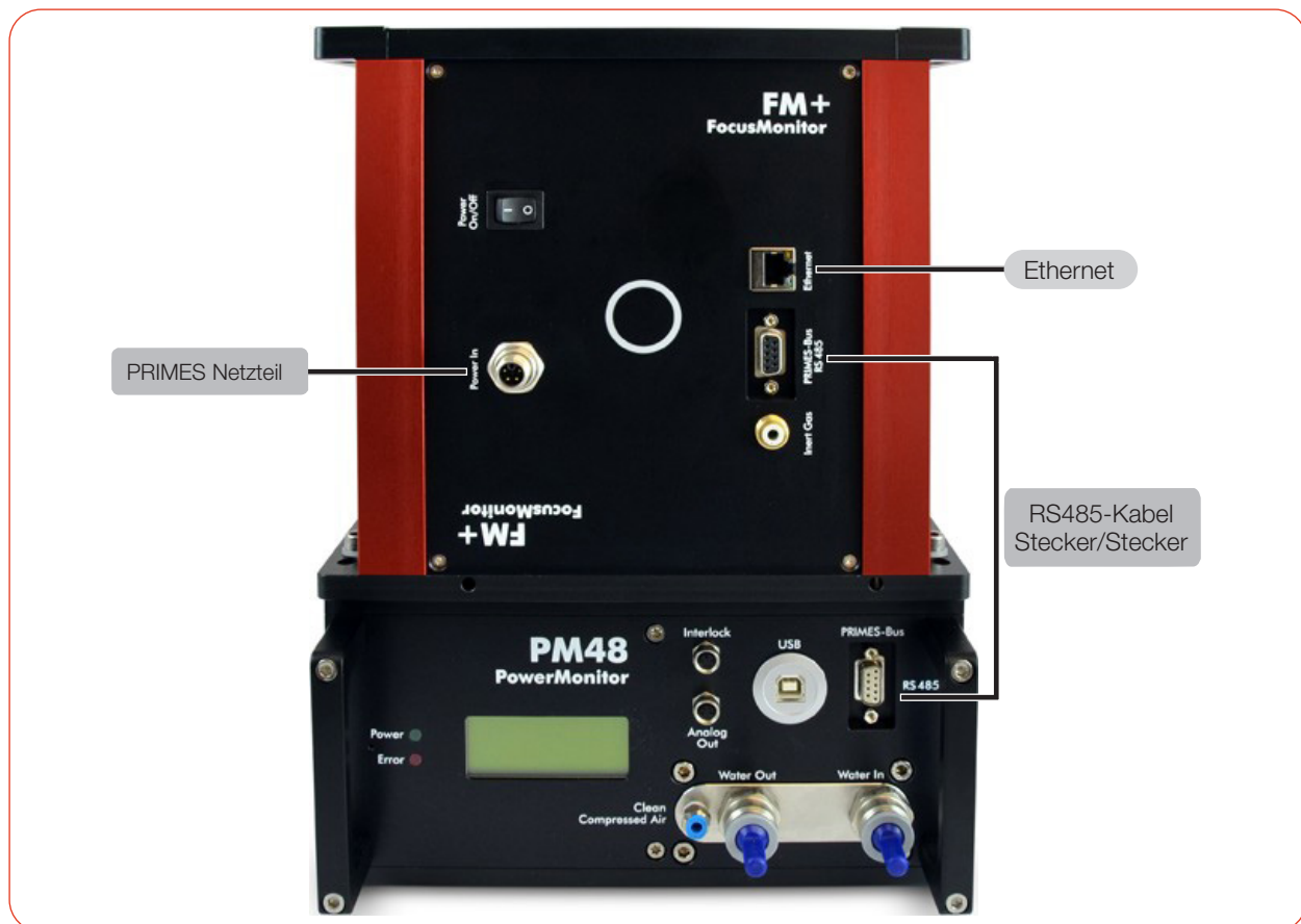
Abb. C.1: Exemplarischer Anschluss eines PM 48 an einen FM+
