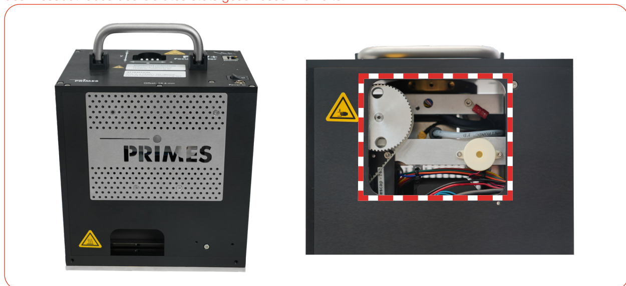
Abb. 4.3: Gefahr durch rotierende Bauteile
