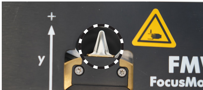
Abb. 1.1: Verletzungsgefahr durch gestreute oder gerichtete Reflexionen des Laserstrahls
