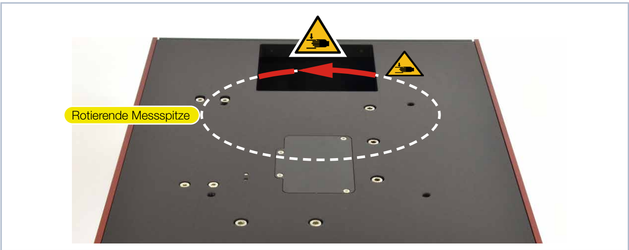
Abb. 4.3: Gefahr durch die rotierende Messspitze am Beispiel des BM+ 100S
