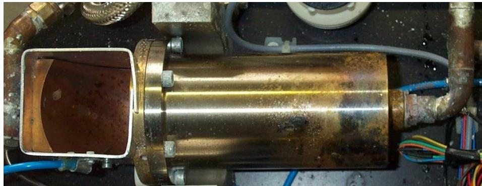
PowerMonitor – Absorber nach Betrieb ohne Kühlung
